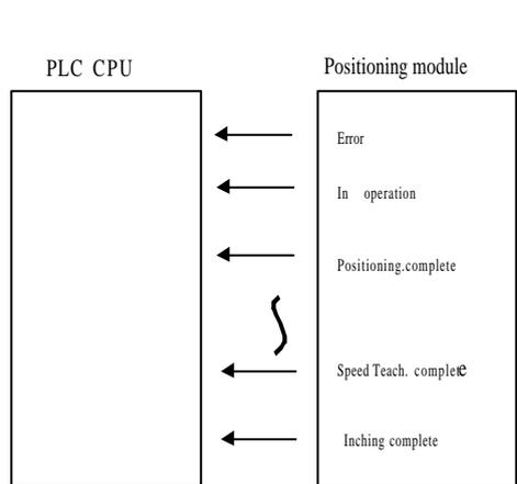
【Fig.10.3】 Input signal of positioning module
